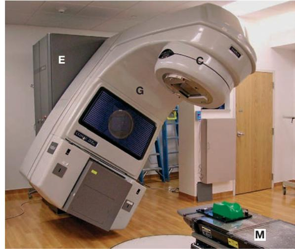
**FIGURA 28-3** Fotografia de um acelerador linear atualmente utilizado no Southwestern Medical Center da Texas University. O paciente se deita na mesa de tratamento. O *gantry* (G), a mesa (M) e o cabeçote (C) podem girar, permitindo que os feixes de radiação atinjam os tecidos-alvo por diferentes ângulos. E = estrutura estacionária.
