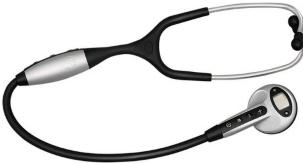
Figura 1.3 Estetoscópio eletrônico da Divisão de Cardiologia do Departamento de Clínica Médica da FMRP-USP; a parte menor mostra a face da cápsula que toca o paciente. Este aparelho possibilita ajustes para apurar a ausculta, mas o modelo não é dotado de recursos para fazer conexão com sistemas computadorizados.
