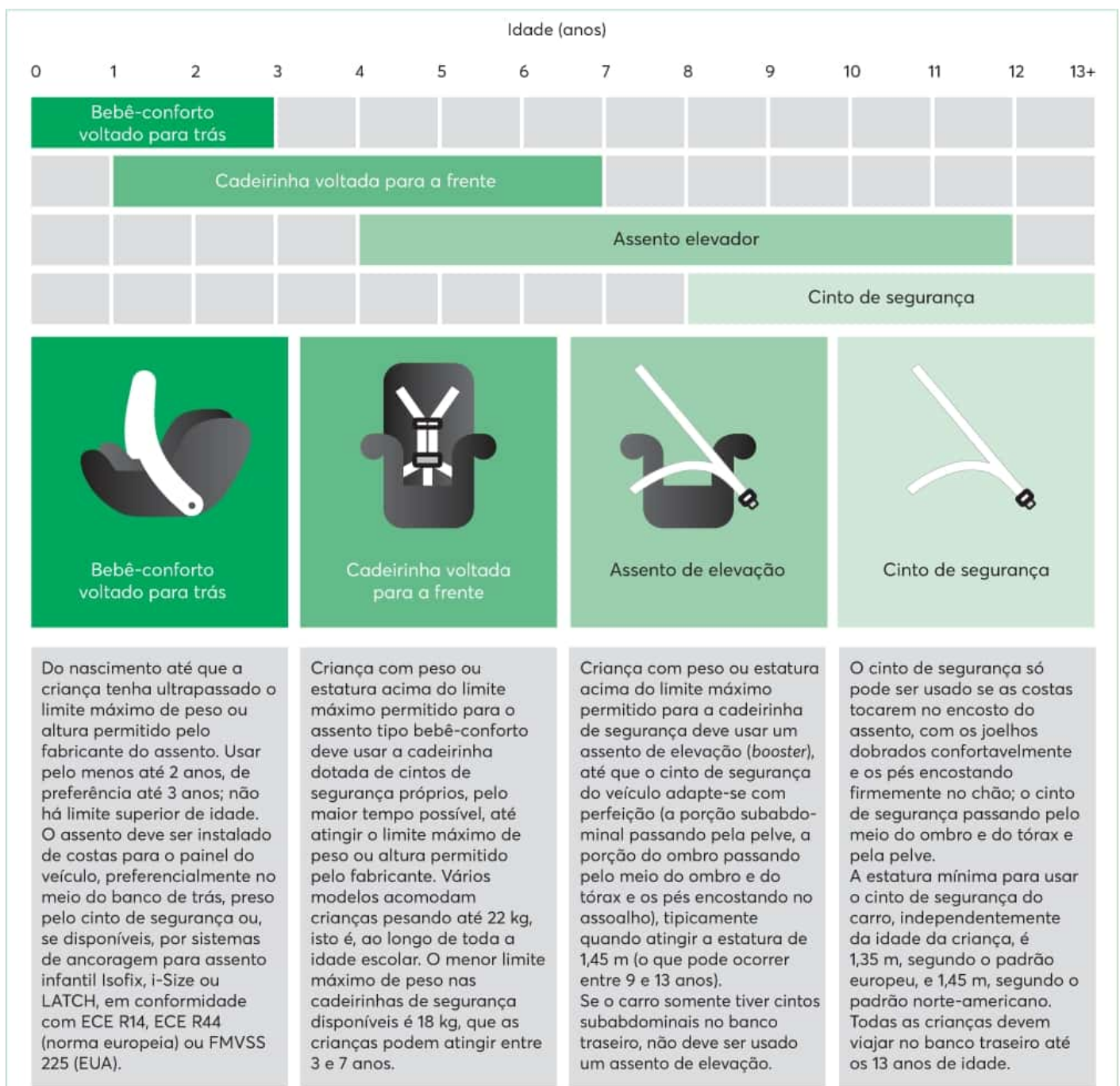
Figura 1 Recomendações para o uso dos dispositivos de segurança para crianças e adolescentes ocupantes de veículos automotores.
