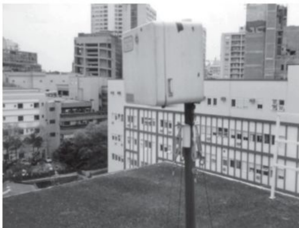
Figura 2 Equipamento Rotorod Sampler® para coleta de esporos de fungos anemófilos.
